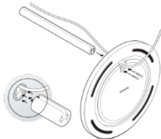
3. Führe das Stromkabel des Speakers durch die Speaker-Platte.
